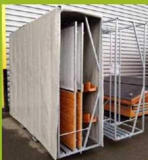
Le chalet intérieur galerie marchande est stocké, transporté et manipulé dans un rack sur roulettes, il contient douze éléments à assembler.
